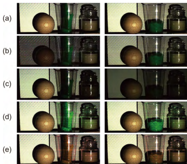
図 3 動的シーンにおける光源色ごとの直接・大域成分の分離とその質感編集・照明シミュレーションへの応用
