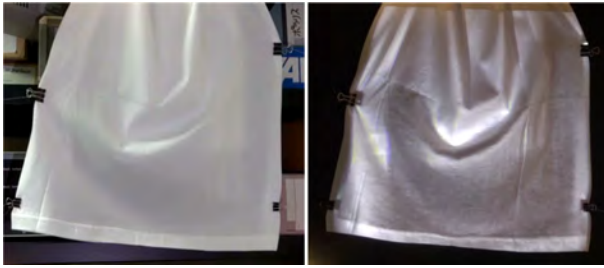
図 6: 柔らかさ印象を操作する映像投影 (左: 投影前, 右: 投影結果)
