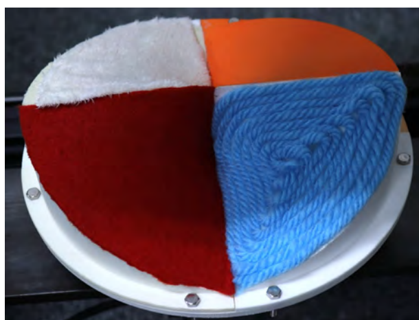
図 1. 実物体を用いた 3 次元ディスプレイ。上段：毛糸で生成された立体視可能なパンダの提示結果。中段：構築したポリュメトリックディスプレイシステム。下段：システムで利用されたスクリーン
