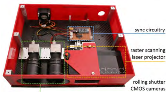
図 6：時間同期式プロジェクターカメラシステム。
