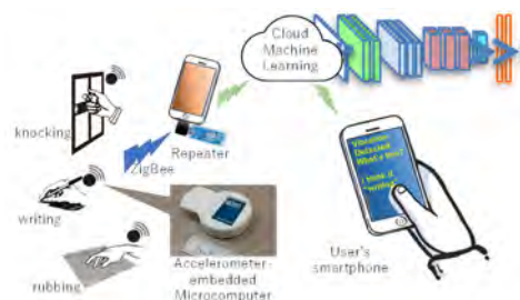
図 1 触覚情報収集システムと機械学習による分類 目指します。
