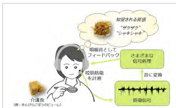
咀嚼筋電音フィードバックによる食質感の変容
