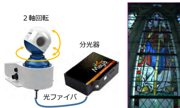
図 8：パノラマ分光計測システム。
