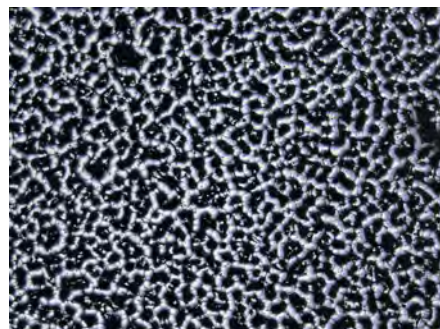
図 3. 乾湿感のための触覚サンプル。PDMS を酸素ドライエッチングにより表面を形成しました。
