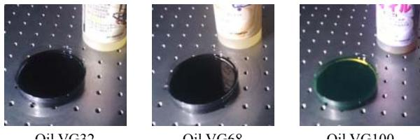
図 5 : オイルを用いた粘弾性推定実験
