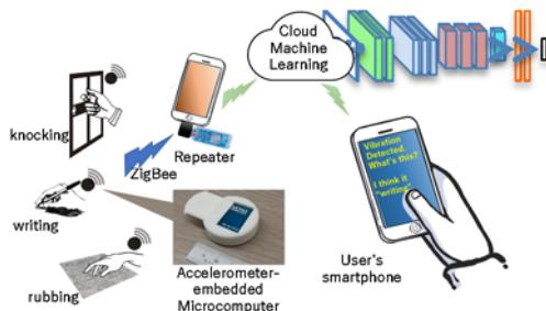
図 1 触覚情報収集システムと機械学習による分類
